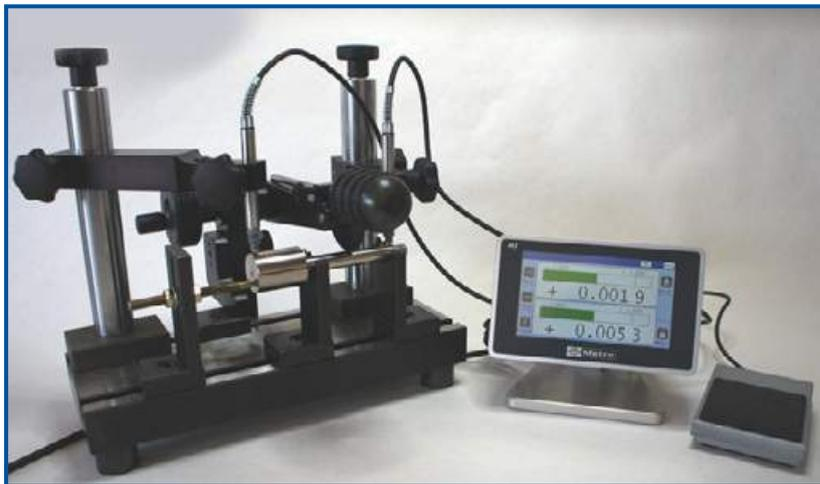
Hochgenaue Durchmesserprüfung mit einer Feinzeiger-Rachenlehre und Anzeige über ein digi 3plus Kompaktanzeigegerät.
