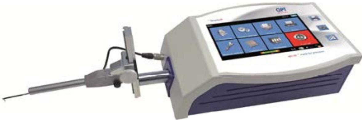
Das portable Oberflächenmessgerät **Smartic M** mit integrierter Auswerteeinheit und wechselbarem Freitastsystem vereint Mobilität mit hochgenauen Messungen nach Normen: ISO 4287, ISO 13565, ISO 12085, DIN 4768, VDA 2007, JIS B0671, JIS B0601, JIS, B0631, ASME B46.1.
