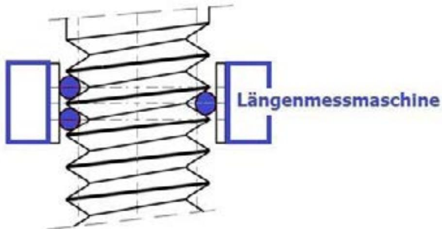
Das Dreidraht-Messverfahren ist ein präzises Verfahren zur Bestimmung des Flankendurchmessers von Gewinden. Diese Methode ist jedoch sehr zeitaufwendig und erfordert viel Erfahrung durch den Messtechniker. Auch wird nur ein kleiner Bereich der Gewindelänge und nur ein Merkmal beurteilt.
