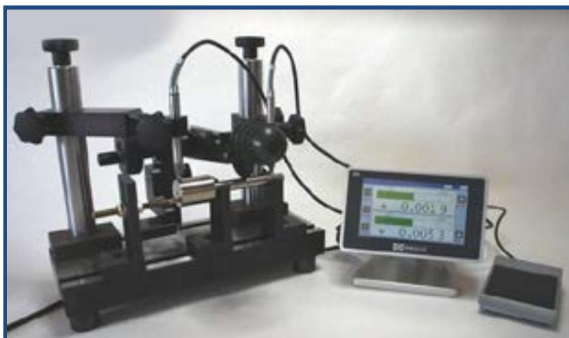
Hochgenaue Durchmesserprüfung mit einer Feinzeiger-Rachenlehre und Anzeige über ein digi 3plus Kompaktanzeigergerät.
