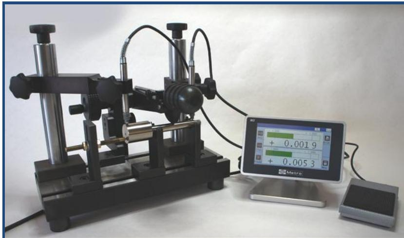
Hochgenaue Durchmesserprüfung mit einer Feinzeiger-Rachenlehre und Anzeige über ein digi 3plus Kompaktanzeigergerät.
