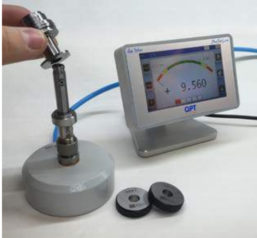
digi 1pneu Kompaktanzeigergerät - BlueFairLine Technische Daten wie digi 3plus
