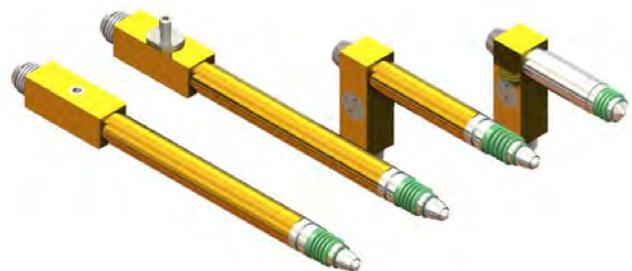
Hirt-Taster basieren auf einem induktiven Messsystem und sind mit Messbereichen  $\pm 1$  bis  $\pm 5$  mm lieferbar. Alle Tastergehäuse (außer T200-Serie) sind mit Titan-Nitrid beschichtet. Als Linearführung wird eine vorgespannte und handgeläppte Kugelführung eingesetzt. Die Induktivtaster sind auf Wunsch in verschiedenen Abgleichen und Sonderausführungen lieferbar.
